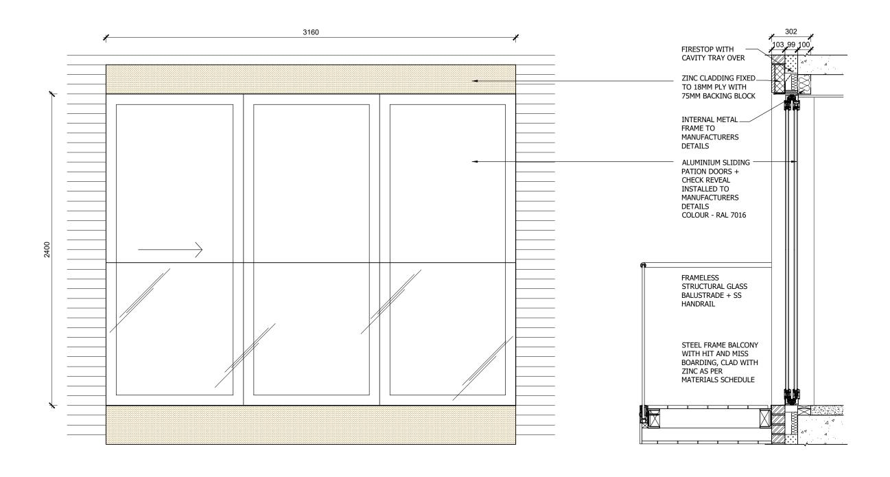
TYPICAL ALUMINIUM SLIDING PATIO DOORS & BALCONY FIRST & SECOND FLOORS ONLY **BLOCK A - FRONT AND REAR ELEVATIONS BLOCK B - REAR ELEVATION**
