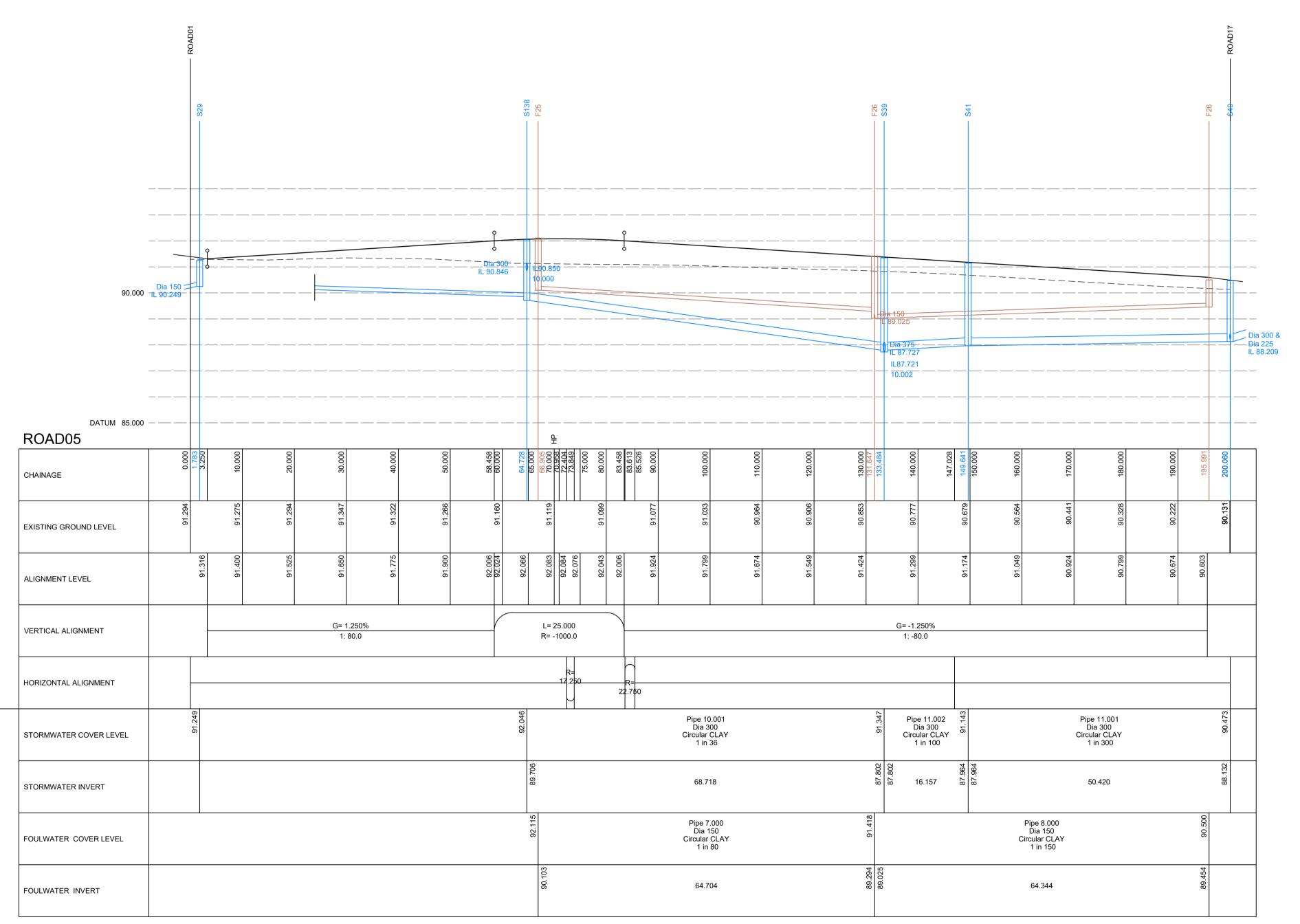
ROAD5 & DRAINAGE LONGITUDINAL SECTION
