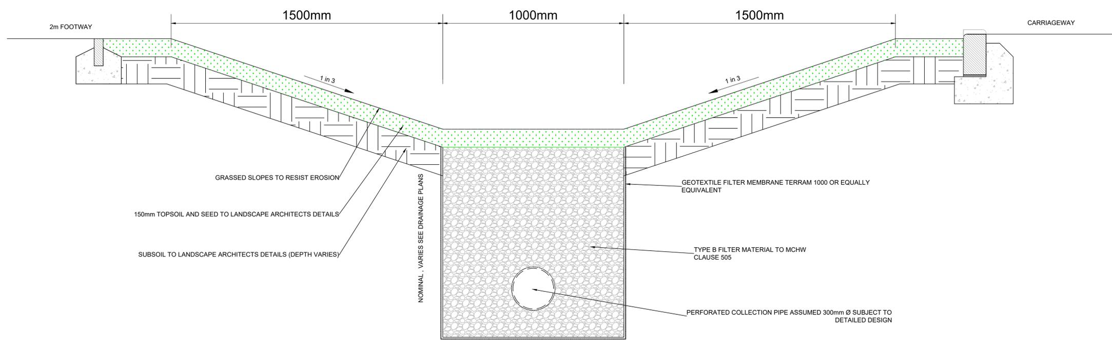
TYPICAL UNDERDRAINED PRIMARY SWALE CONSTRUCTION
