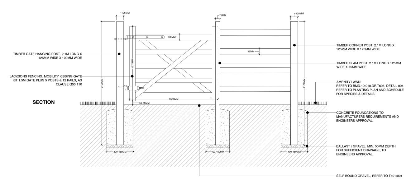
TIMBER CORNER POST. 2.1M LONG X 125MM WIDE X 125MM WIDE TIMBER SLAM POST. 2.1M LONG X 125MM WIDE X 75MM WIDE
