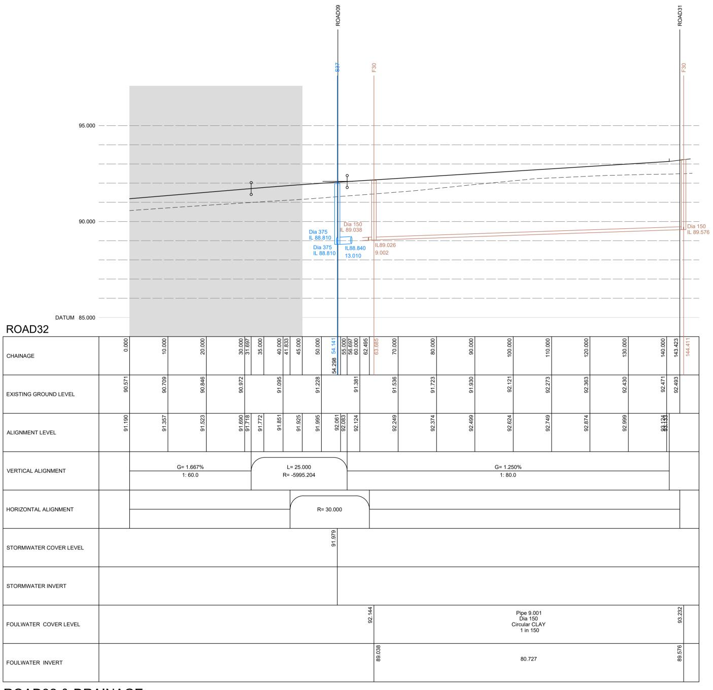
**ROAD32 & DRAINAGE** LONGITUDINAL SECTION
